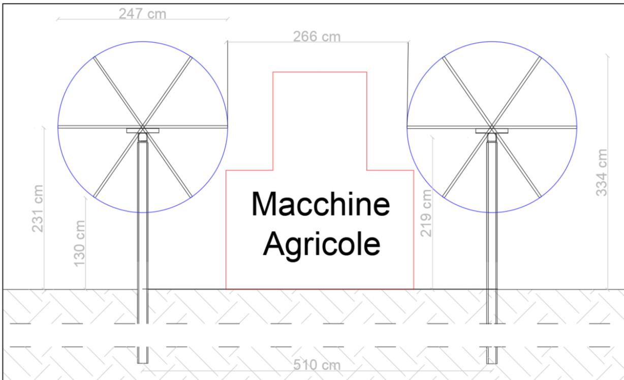
FIGURA 6: CONFIGURAZIONE STRUTTURE AD INSEGUIMENTO IMPIANTO AGRIVOLTAICO
