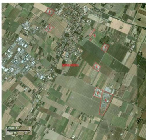
Figura 1 - Principali infrastrutture della Concessione Minerbio Stoccaggio (base: immagine satellitare Google): (1) centrale compressione; (2) centrale trattamento; (3) cluster B; (4) cluster C; (5) cluster E-E1; (6) cluster A; (7) cluster D.
