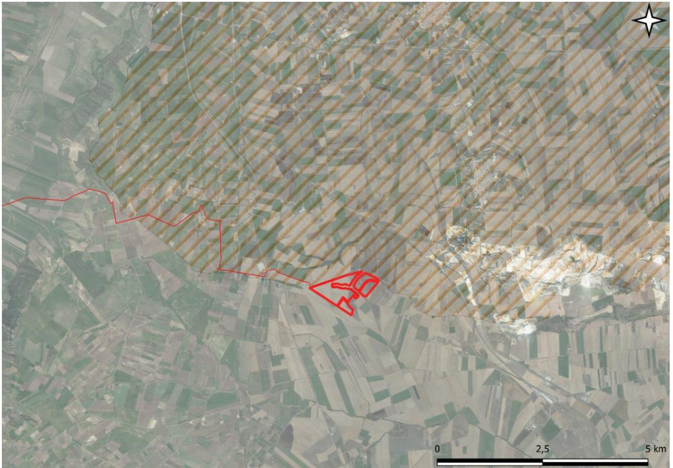
**Figura 11- Interferenza cavidotto di progetto con AREA SENSIBILE, identificata dalla cartografia allegata al Piano di Tutela delle Acque della Regione Puglia**
