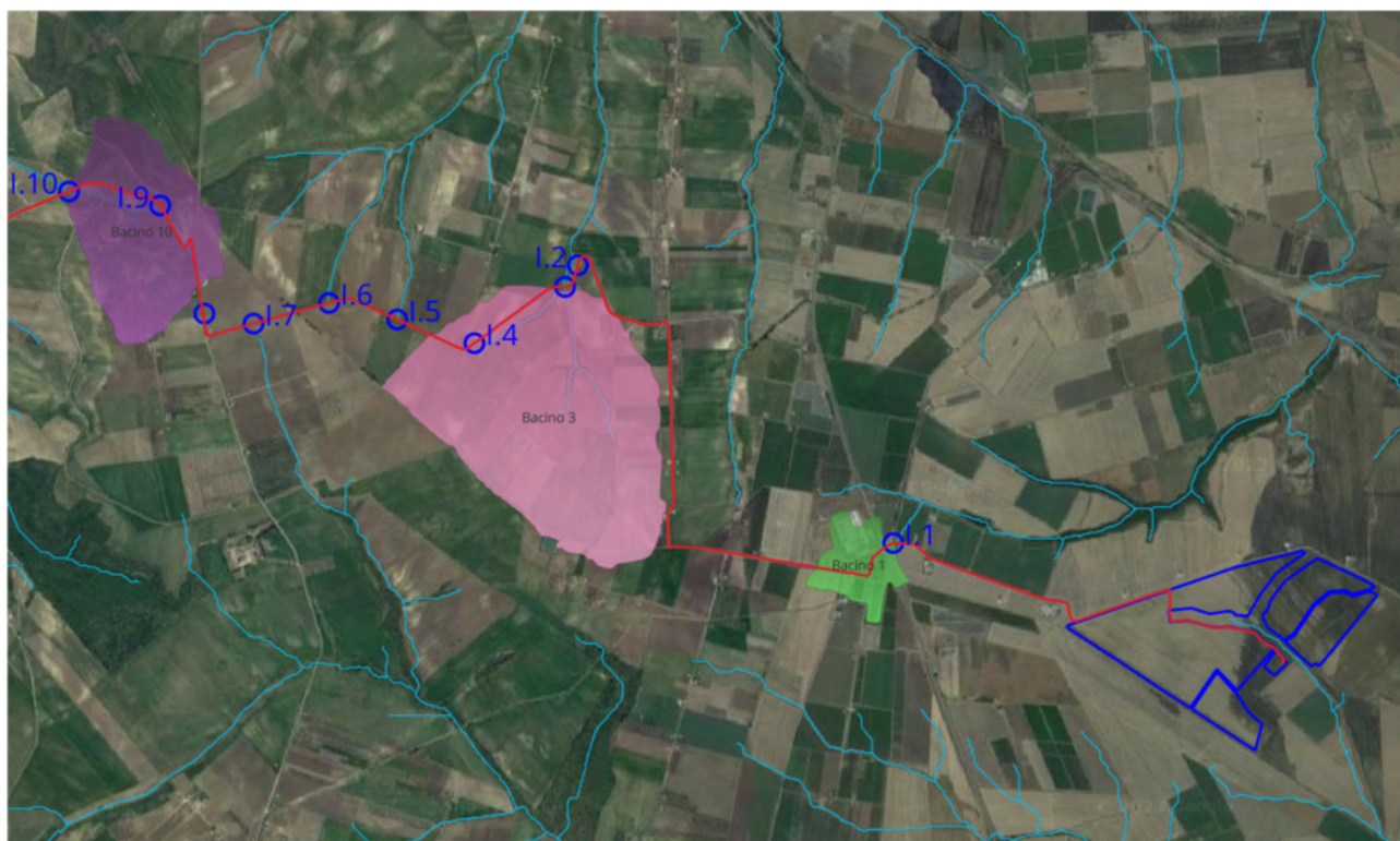
Figura 8 - Rappresentazione dei bacini idrografici 1.1 -1.3-1.10 di monte relativi alle interferenze idrauliche
