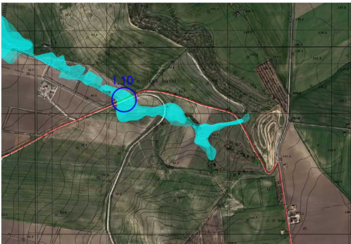
Figura 33 - Rappresentazione del tratto di TOC (in verde) per la I.10
