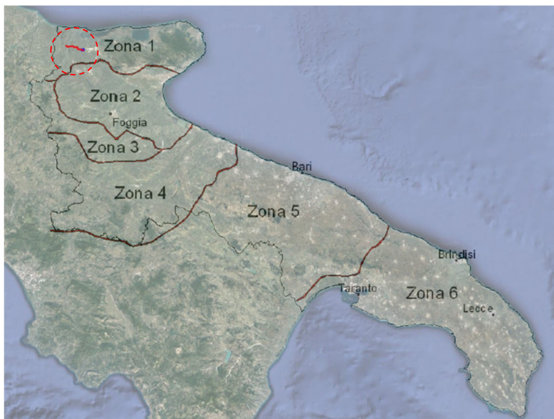
Figura 12 - Inquadramento dell'area oggetto di analisi (in magenta) rispetto alle zone pluviometriche omogenee (Fonte: Vapi Puglia)
