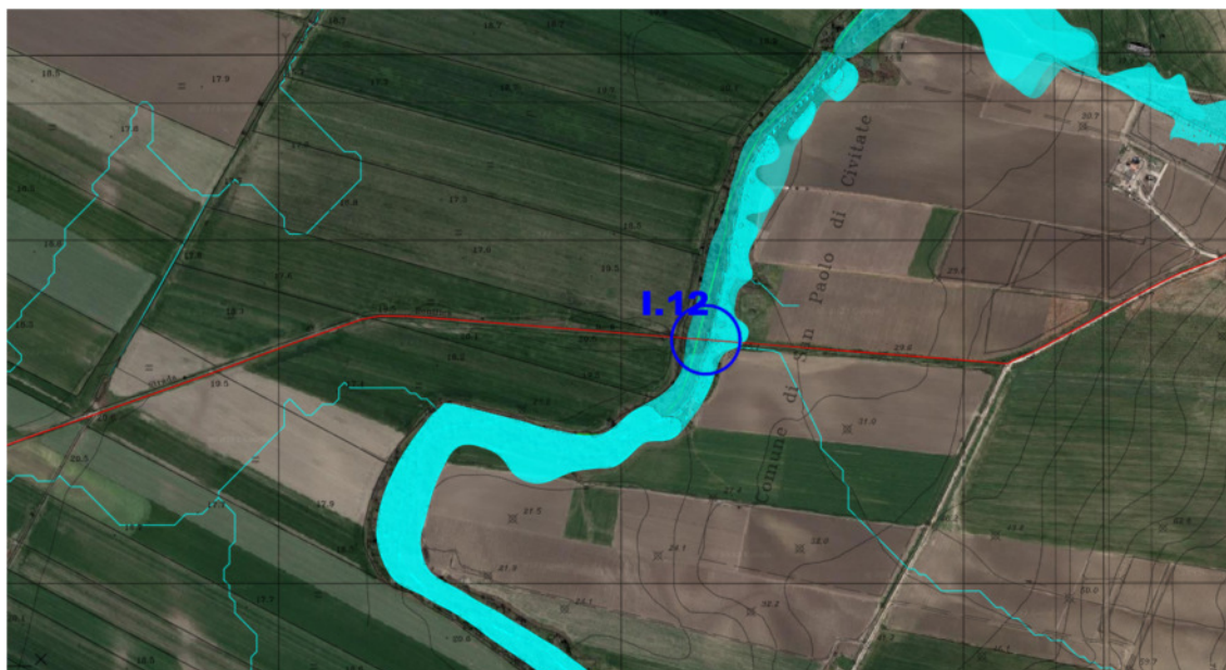
Figura 36 - Rappresentazione dell'area inondabile ottenuta dalla modellazione idraulica bidimensionale per la I12
