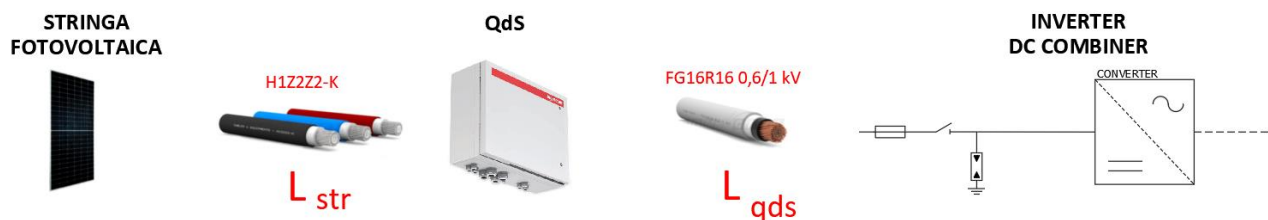
Figura 14. Collegamento elettrico lato DC
