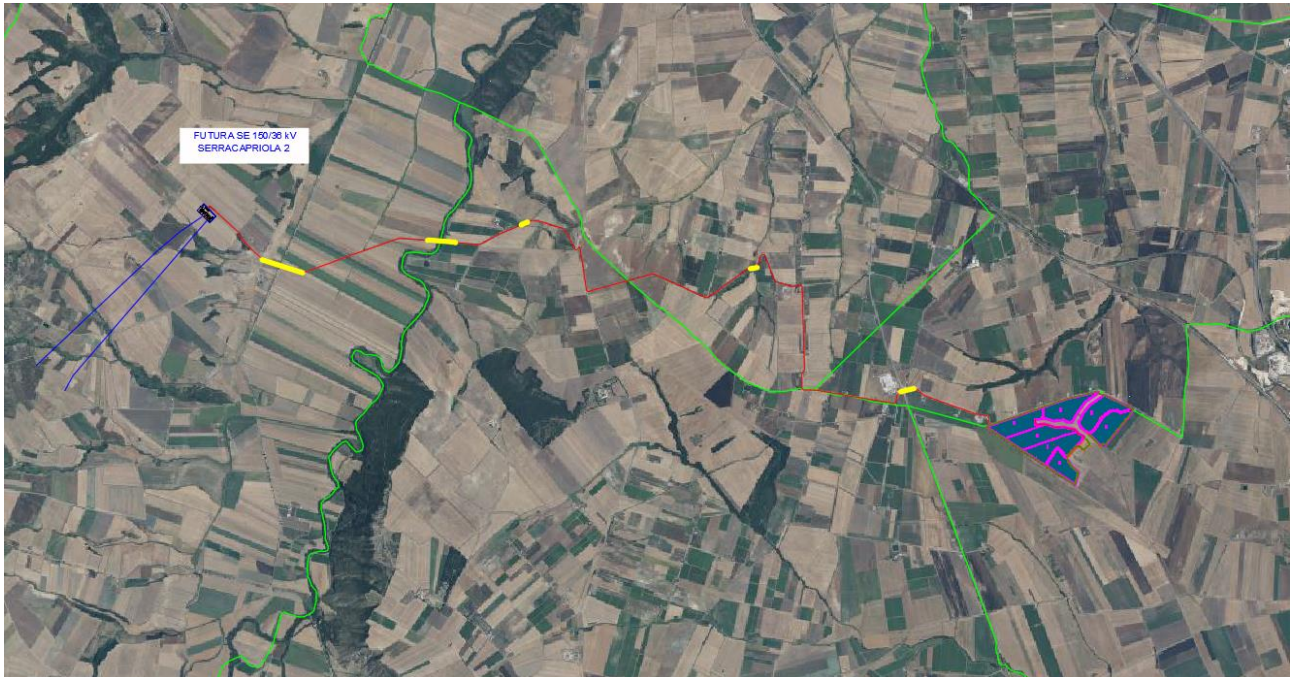
Figura 29. Cavidotto di collegamento alla SE su ortofoto
