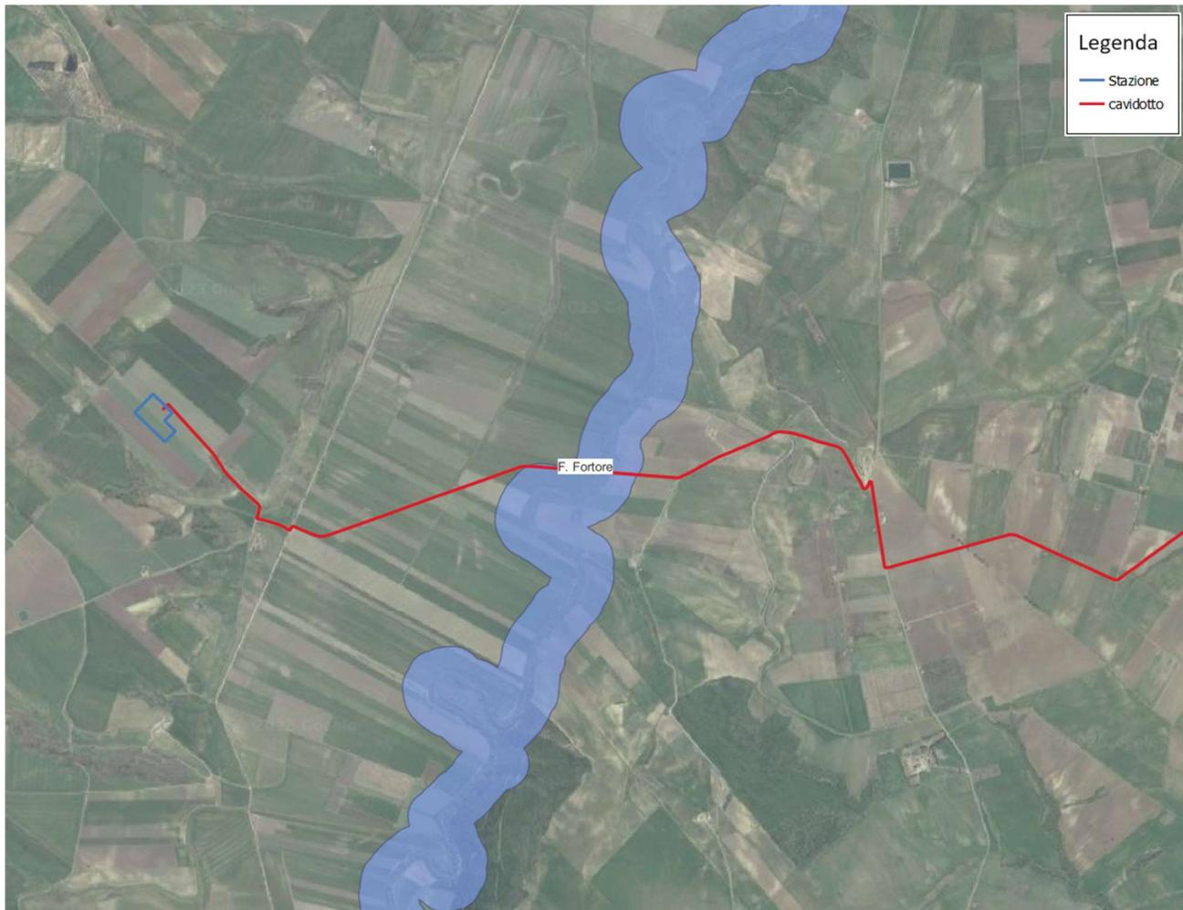
Figura 6 Inquadramento del tracciato del cavidotto interrato e della sottostazione su ortofoto con evidenza su Fiume Fortore
