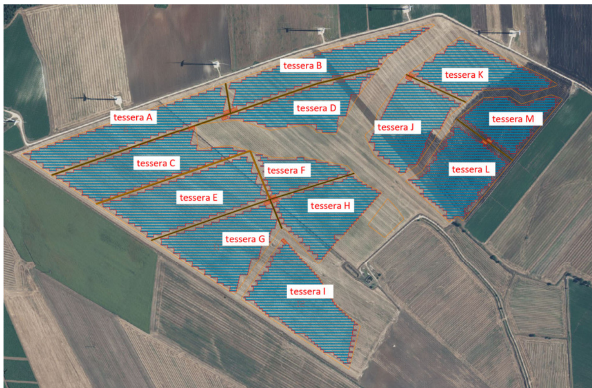
Figura 11. configurazione layout con definizione tessere in assetto fixed
