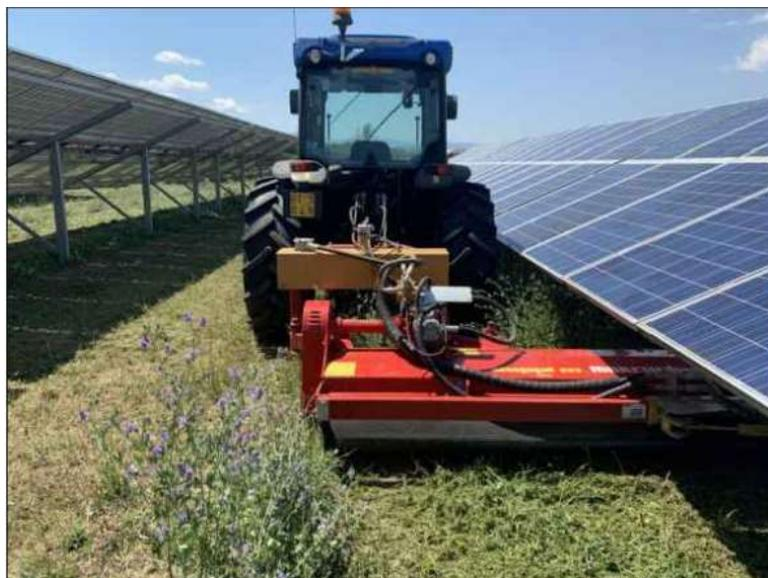
Figura 9 Trinciatura del cotico erboso con barra falciante
