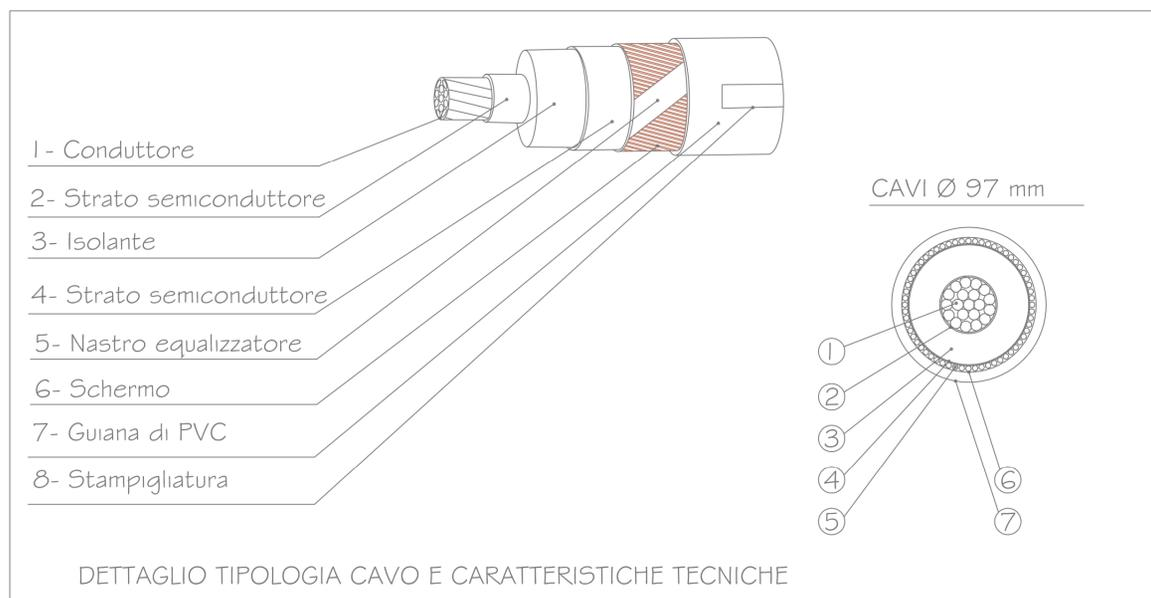
DETTAGLIO TIPOLOGIA CAVO E CARATTERISTICHE TECNICHE
