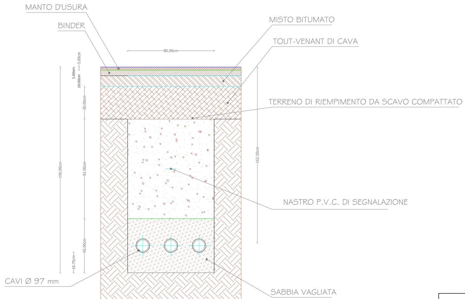
SEZIONE TIPO CAVIDOTTI ALTA TENSIONE
