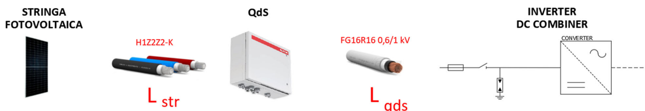
Figura 11 Collegamento elettrico LATO DC
