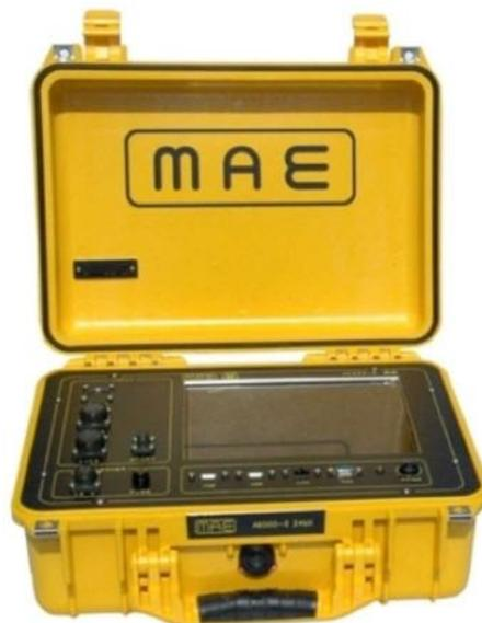
**Fig.2** – Sismografo M.A.E. A6000S.
