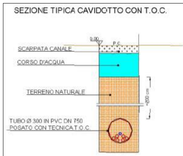
Figura 11. Sezione tipica di attraversamento in TOC.
