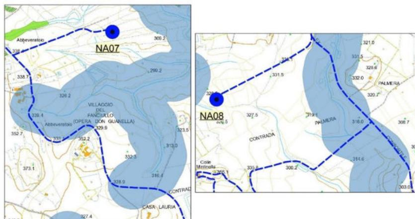
Figura 47: Individuazione su CTR delle interazioni del cavidotto AT 36 kV interno al parco con fiumi, torrenti e corsi d'acqua tutelati ai sensi dell'art. 142 lett. c (buffer 150 m)
