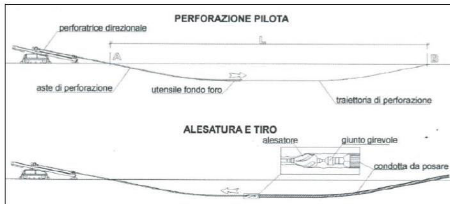
Figura 14: Schematico di trivellazione orizzontale controllata.
