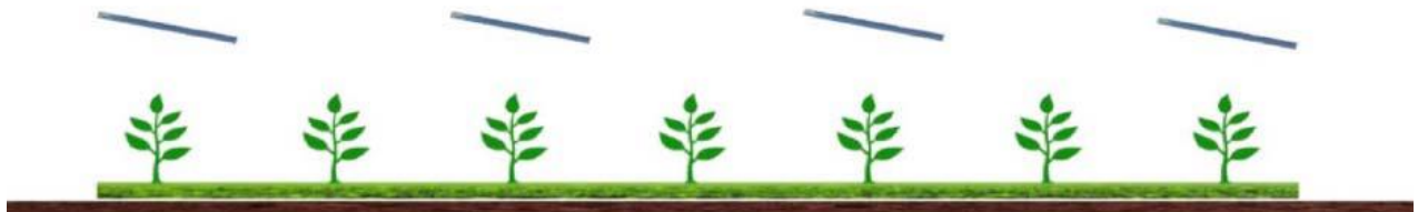
Figura 5 – Rappresentazione schematica di sistema agrivoltaico con coltivazione sia tra le file che al di sotto dei pannelli (Da A. Scognamiglio, ENEA).
