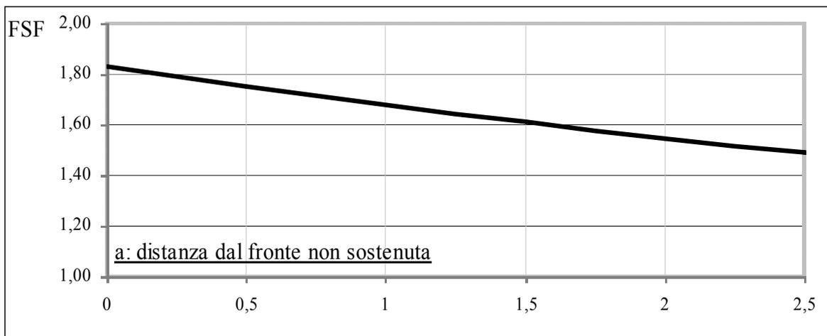
Come si osserva il comportamento del fronte in assenza di consolidamenti è marcatamente di tipo c, al contrario si riesce a definire una configurazione di stabilità adottando un intervento di precontenimento del fronte mediante l'utilizzo di barre in VTR.
