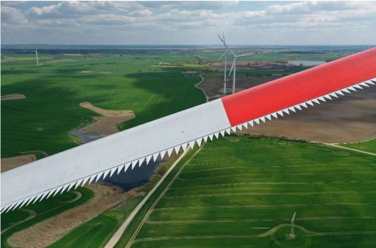
Figura 13. Dettaglio Pala Eolica Serrated Trailing Edge (STE)
