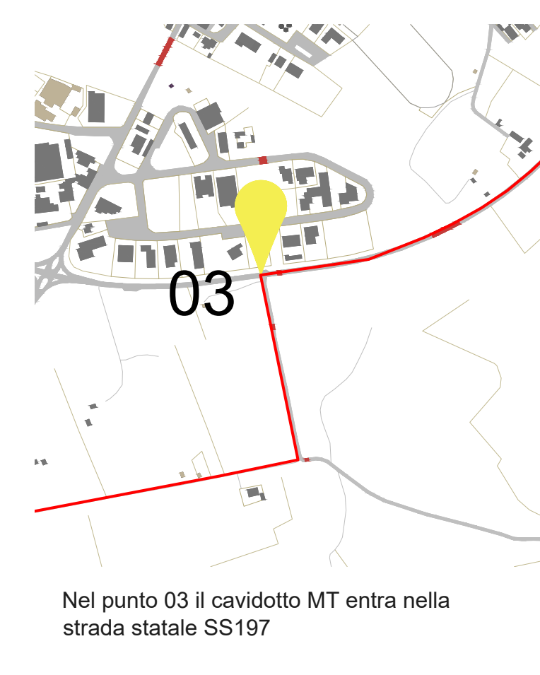
03- Accesso su strada SS197
