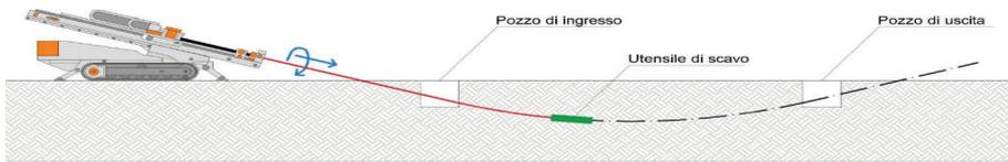
2) Perforazione pilota (pilot bore): mediante una macchina operatrice si realizza una perforazione normalmente di piccolo diametro che viene manovrata attraverso la combinazione di rotazioni e spinte il cui effetto, sulla traiettoria seguita dall'utensile di scavo, è controllata attraverso un sistema di guida radiocontrollato. La perforazione pilota può seguire percorsi plano-altimetrici preassegnati che possono contenere anche tratti curvilinei.
