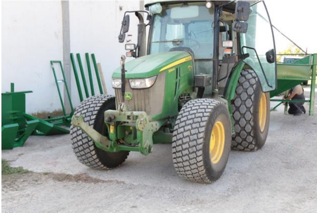
Figura 23 - Trattore equipaggiata con gomme anti-compattamento atte a non distruggere le caratteristiche fisiche del suolo
