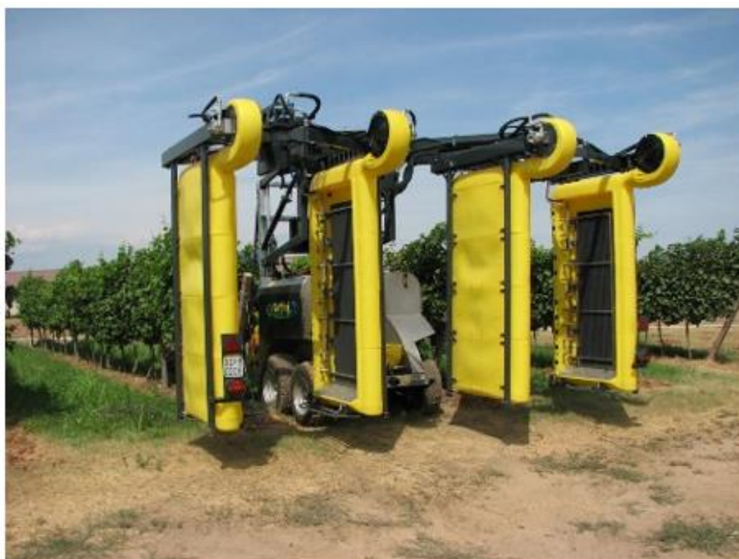
Figura 14 - Vista di atomizzatore per pareti continui con barre per il recupero della deriva dei prodotti fitosanitari
