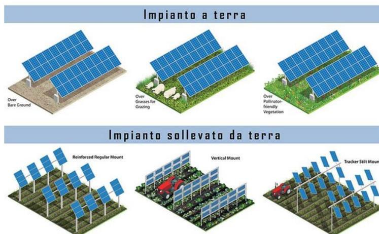
Figura 18 - Tipologie di impianti agrivoltaici, fonte NREL
