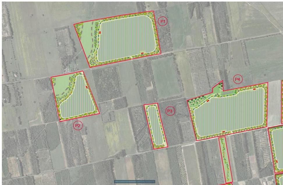
*Figura 149 - Esempio di Piastre e trattamento di bordo per continuità ecologica*
