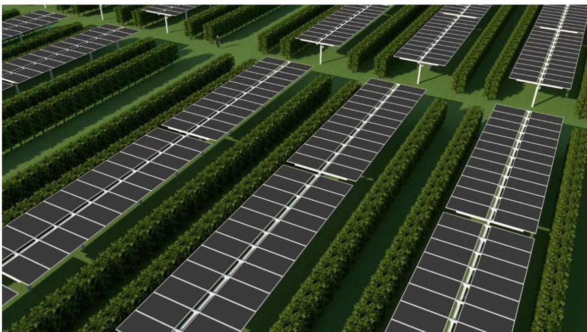
*Figura 25- Schizzo dell'assetto impiantistico: un filare FV e due siepi ulivicole alternate*
