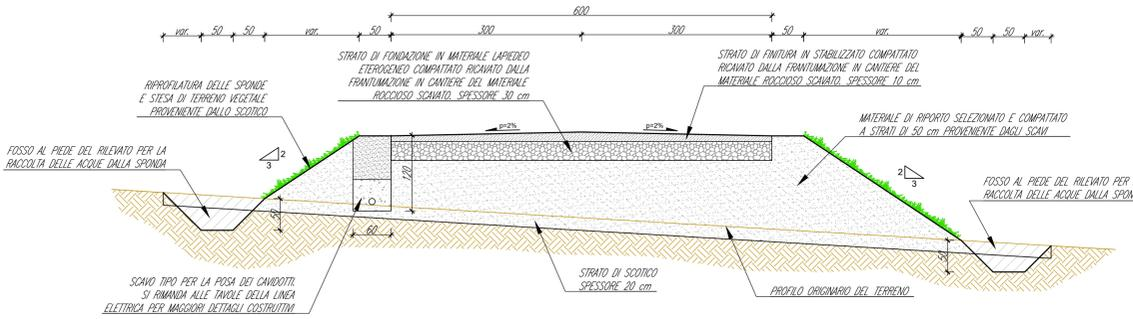
SEZIONE TIPO DELLA NUOVA VIABILITA' IN PROGETTO IN RILEVATO CON FOSSI AL PIEDE
