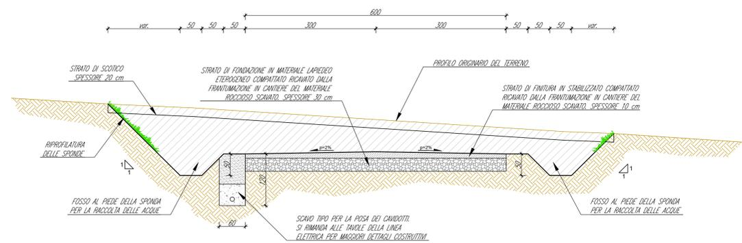
SEZIONE TIPO DELLA NUOVA VIABILITA' IN PROGETTO IN TRINCEA
