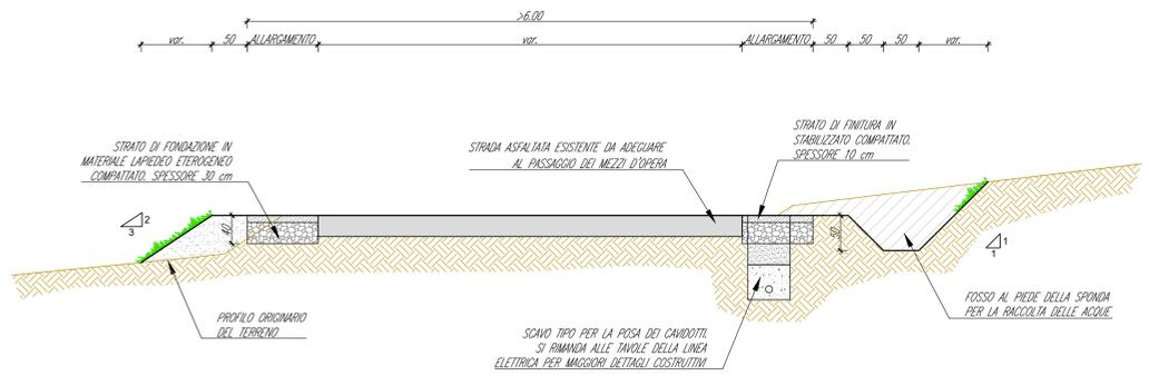
SEZIONE TIPO DELL'ADEGUAMENTO DELLA VIABILITA' ASFALTA/STERRATA ESISTENTE
