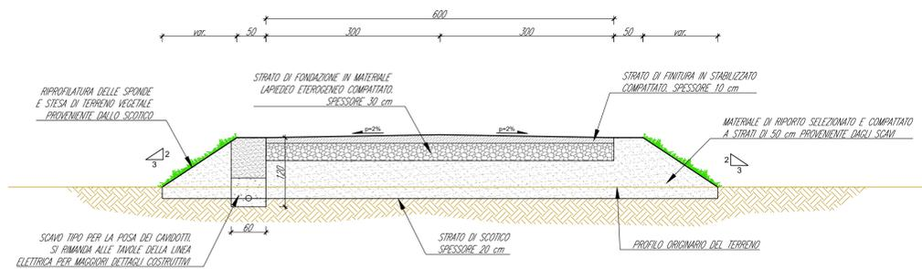
SEZIONE TIPO DELLA NUOVA VIABILITA' IN PROGETTO IN RILEVATO SENZA FOSSI AL PIEDE
