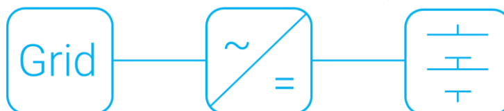
Figura 8 Schema semplificato di un convertitore monostadio
