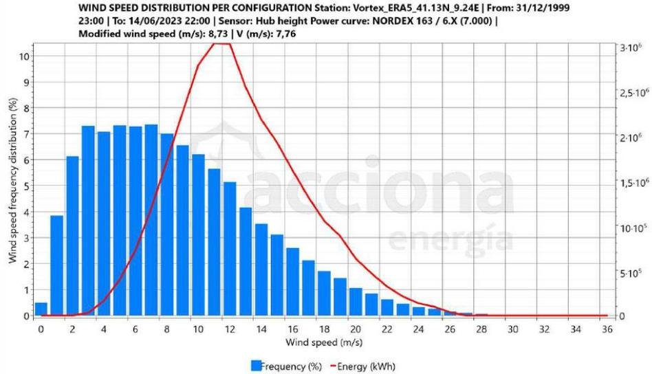
Figura 9 – Energia del singolo aerogeneratore in relazione alla frequenza della velocità del vento.
