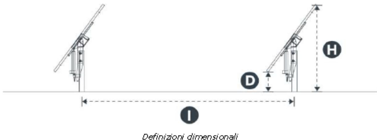
**Fig. 56: Schema interasse dei sostegni fotovoltaici**
