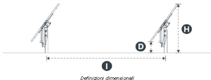
Figura 15: Schema interasse dei sostegni fotovoltaici
