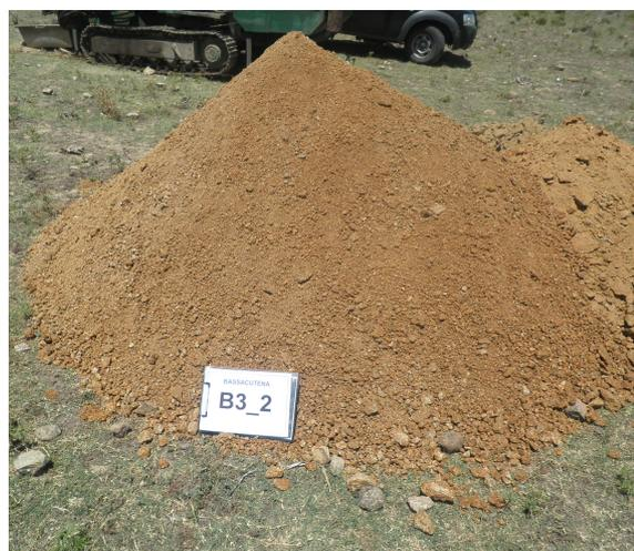
*A sinistra, granitoide “arenizzato” estratto nel sondaggio a carotaggio continuo presso l'aerogeneratore B\_3; si noti che la roccia semicoerente ha mantenuto le strutture originarie. A destra, si noti invece il comportamento allo scavo di tali materiali, che si presentano come sabbie grossolane e/o sabbie ghiaiose incoerenti.*
