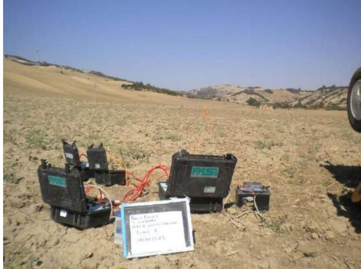
**Tomografia geoelettrica Tomo 01 Area Sottostazione Elettrica**
