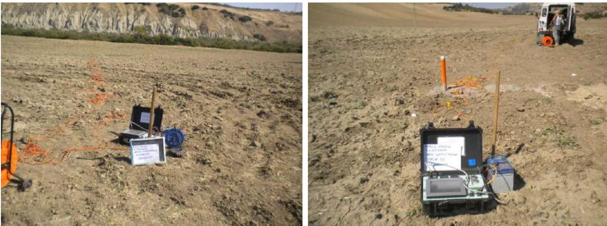
**Indagine sismica Masw01 E Masw02 Area Sottostazione**
