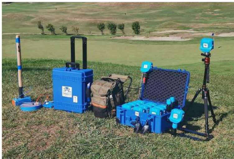
Figura 1. Strumentazione MASW della Donlang Geophysical
