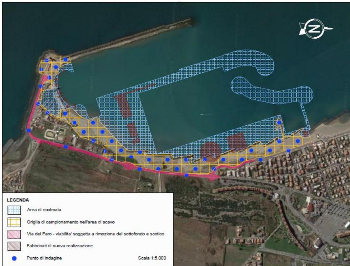
Figura 7.1: Planimetria con ubicazione dei punti di prelievo finalizzati al campionamento per la caratterizzazione ambientale
