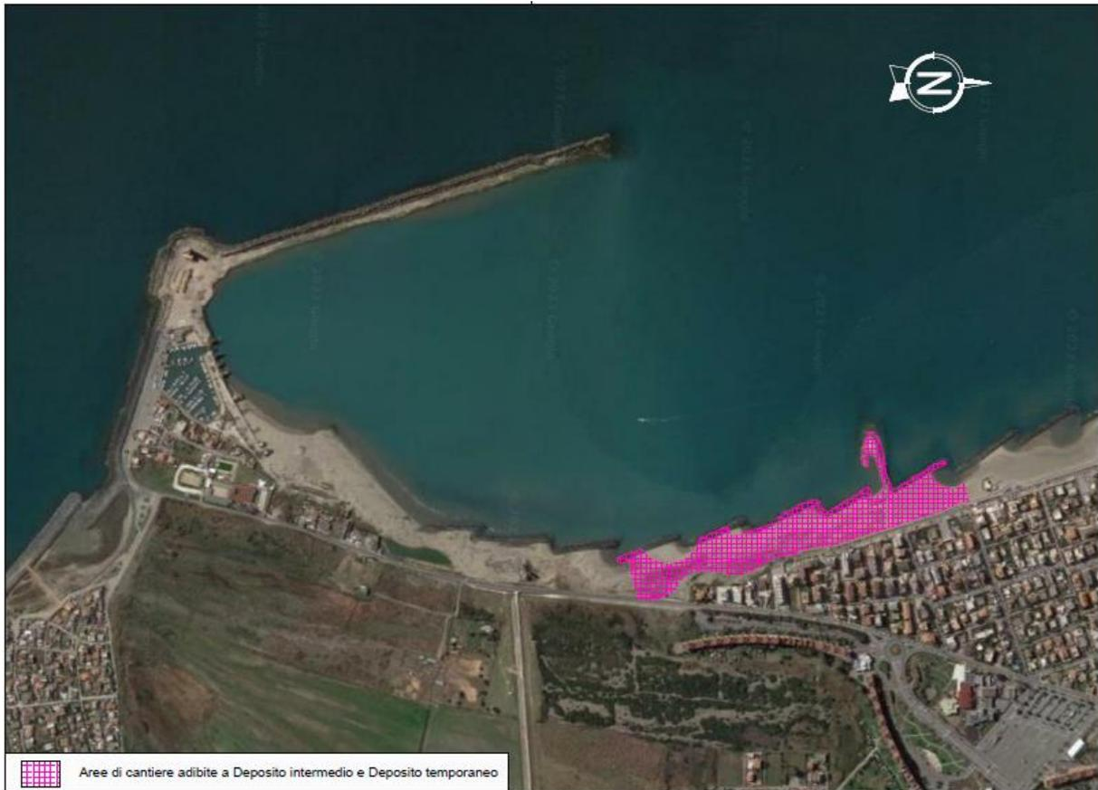
**Figura 6.2: Aree di cantieri, di deposito intermedio e di deposito temporaneo**
