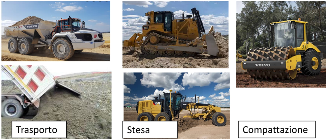
Figura 5.12: Mezzi per la realizzazione del rilevato in vasca.
