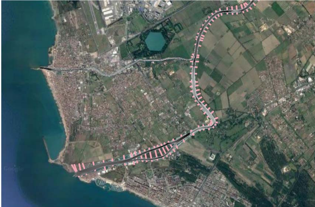
Figura 3-6 Dominio di calcolo monodimensionale. Finche in rosso: rilievo batimetrico per sezioni (1997); in grigio: rilievo batimetrico anno 2020.
