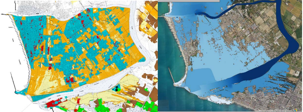
Figura 3-30 Raffronto Mappa PAI Tevere (aggiornamento 2022) - risultati della modellazione idraulica in termini di Elevazione massima raggiunta dalla piena duecentennale
