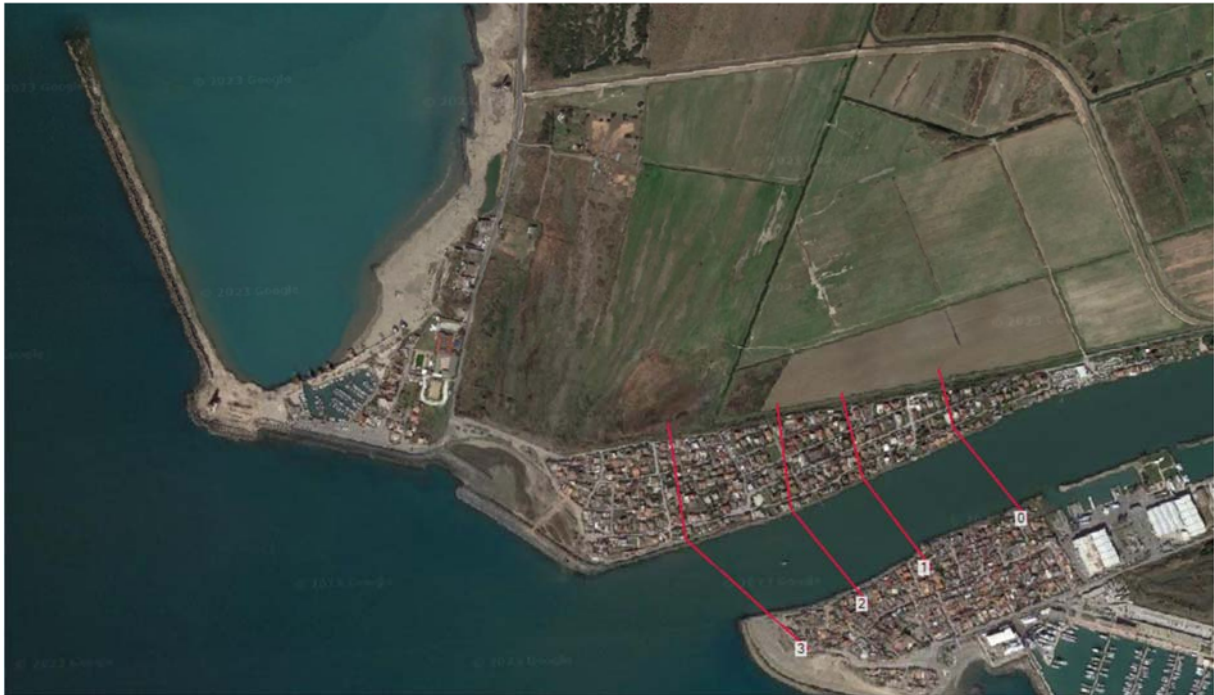
Figura 3-33 Borgo di Fiumara Grande – traccia planimetrica delle sezioni di controllo
