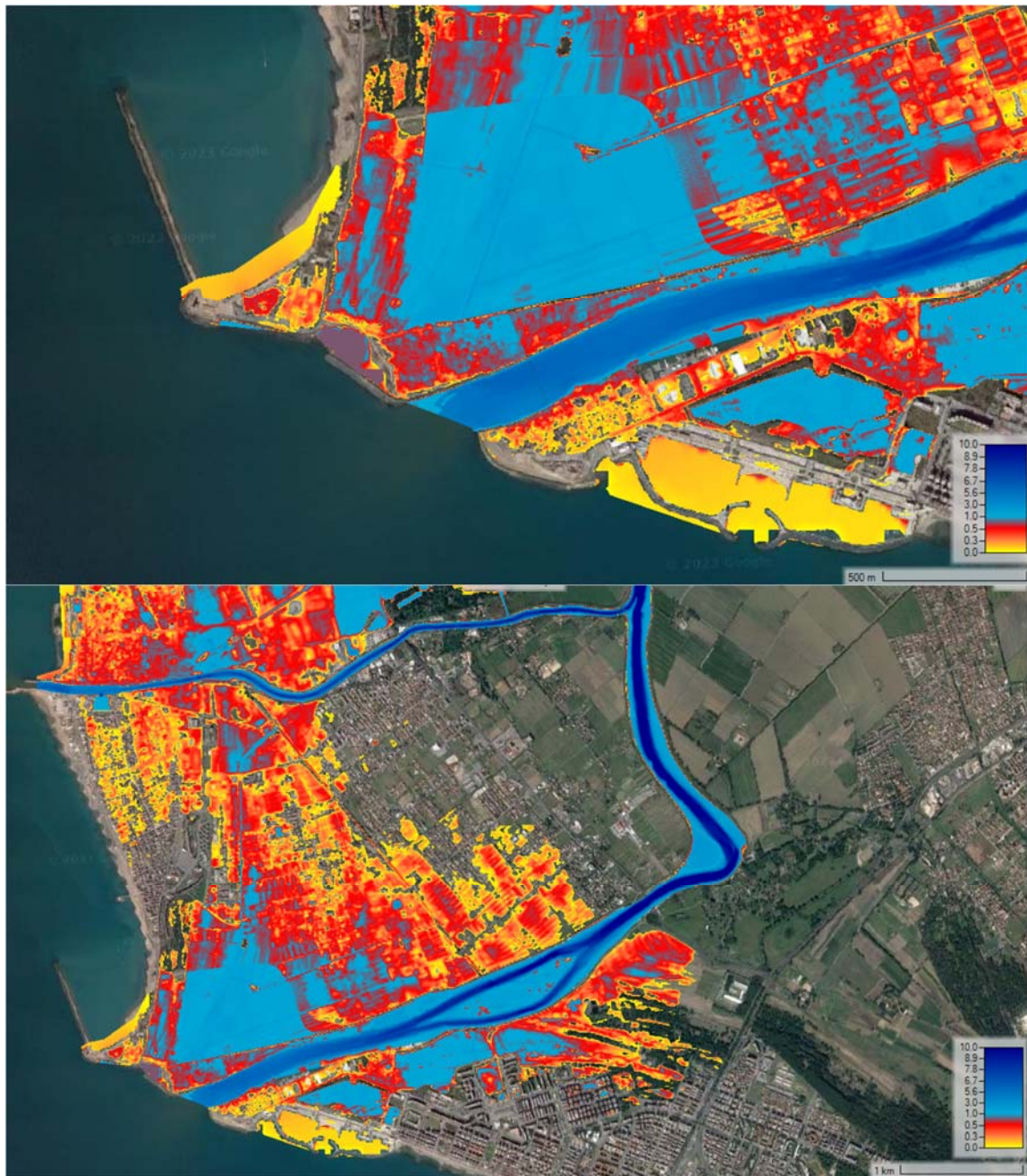
Figura 3-11 Involuppo dei massimi tiranti (massimi livelli idrici registrati durante l'evento di piena rispetto alla quota del terreno) – in alto: inquadramento generale; in basso: inquadramento di dettaglio – area della Fiumara Grande.
