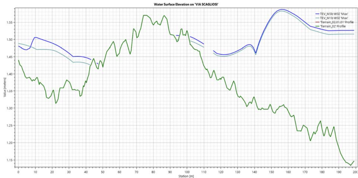
Figura 3-43 - Raffronto Ante-Post Operam del massimo livello idraulico misurato lungo via Scagliosi
