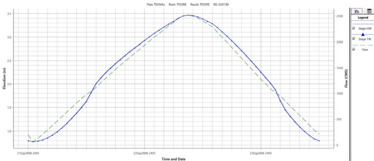
Figura 3-29 Idrogramma di piena – laminazione monte-valle. Onda M2-4B – Sezione a valle di ponte di Tor Boacciana.
