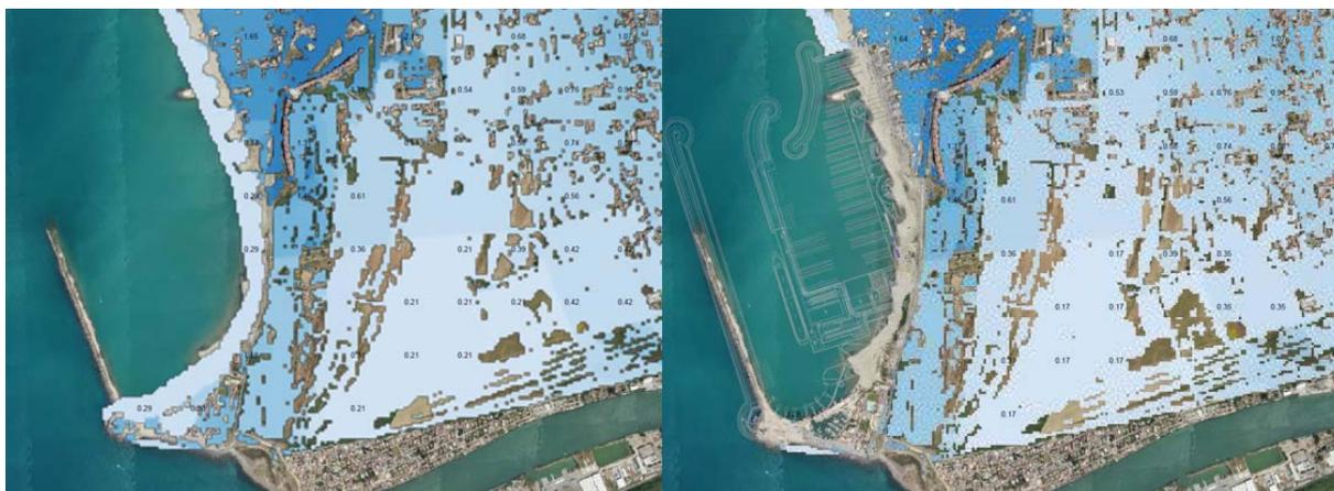
Figura 3-15 Confronto tra ante e post operam sull'area di progetto e limitrofe –Inviluppo delle massime elevazioni idriche; a sinistra, ante operam; a destra: post operam.
