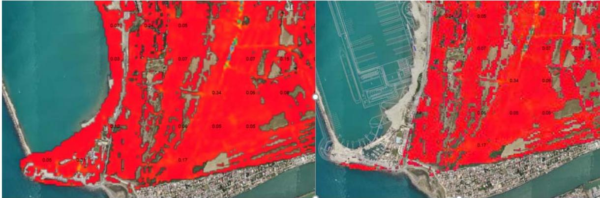
Figura 3-16 -Confronto tra ante e post operam sull'area di progetto e limitrofe – Involuppo delle massime velocità; a sinistra, ante operam; a destra: post operam.
