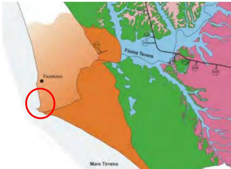
Figura 5.2: Stralcio carta delle unità idrogeologiche ( Capelli e Mazza 2005) In arancio l'Unità Idrogeologica del Delta del Tevere, in verde l'Unità Idrogeologica di Ponte Galeria, in viola l'Unità Idrogeologica dei Colli Albani, in rosa l'Unità Idrogeologica dei Monti Sabatini, in azzurro l'Unità Idrogeologica dei depositi alluvionali recenti e attuali
