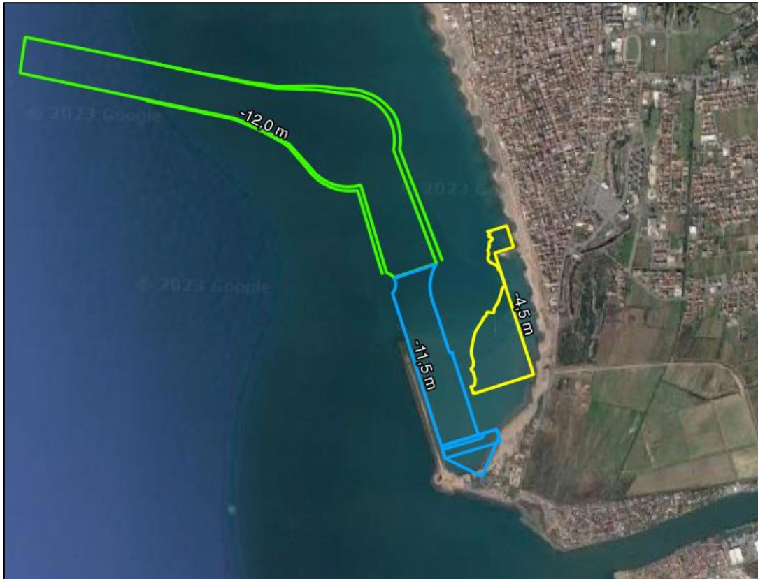
Figura 3.2: Planimetria delle aree di dragaggio (la doppia linea nell'area -12,0 m rappresenta l'ingombro delle scarpate di raccordo).
