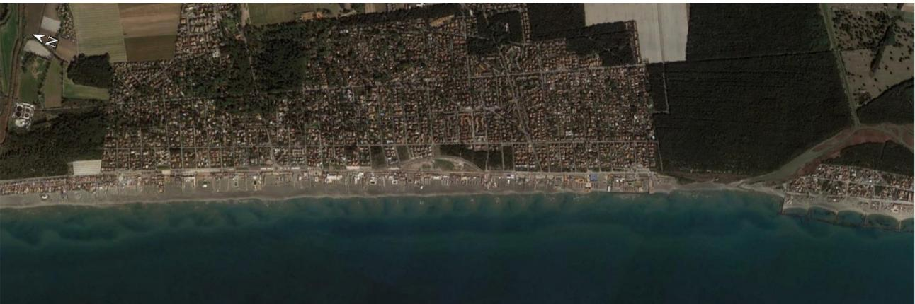
**Figura 18 - Litorale di Fregene nel 2022: apprezzabile il forte arretramento della linea di riva a causa delle forti mareggiate.**
