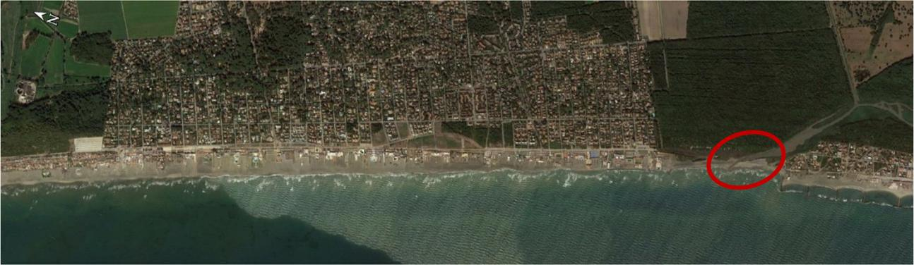
**Figura 14 - Litorale di Fregene (2020); in rosso la foce del fosso, migrata a sud rispetto alla situazione originaria.** Per contrastare questi fenomeni erosivi i gestori degli stabilimenti balneari hanno provveduto inizialmente ponendo in opera sistemi di difesa, quali sacchi in polipropilene riempiti di sabbia (Figura 15).
