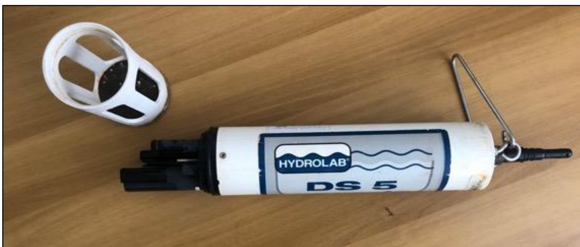
Figura 8 - Sonda multiparametrica Hydras DS5.
