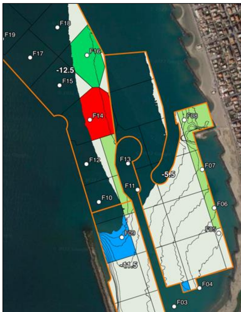
Figura 3.2: Stralcio della planimetria riportante le classi di sedimento per sezioni di scavo
