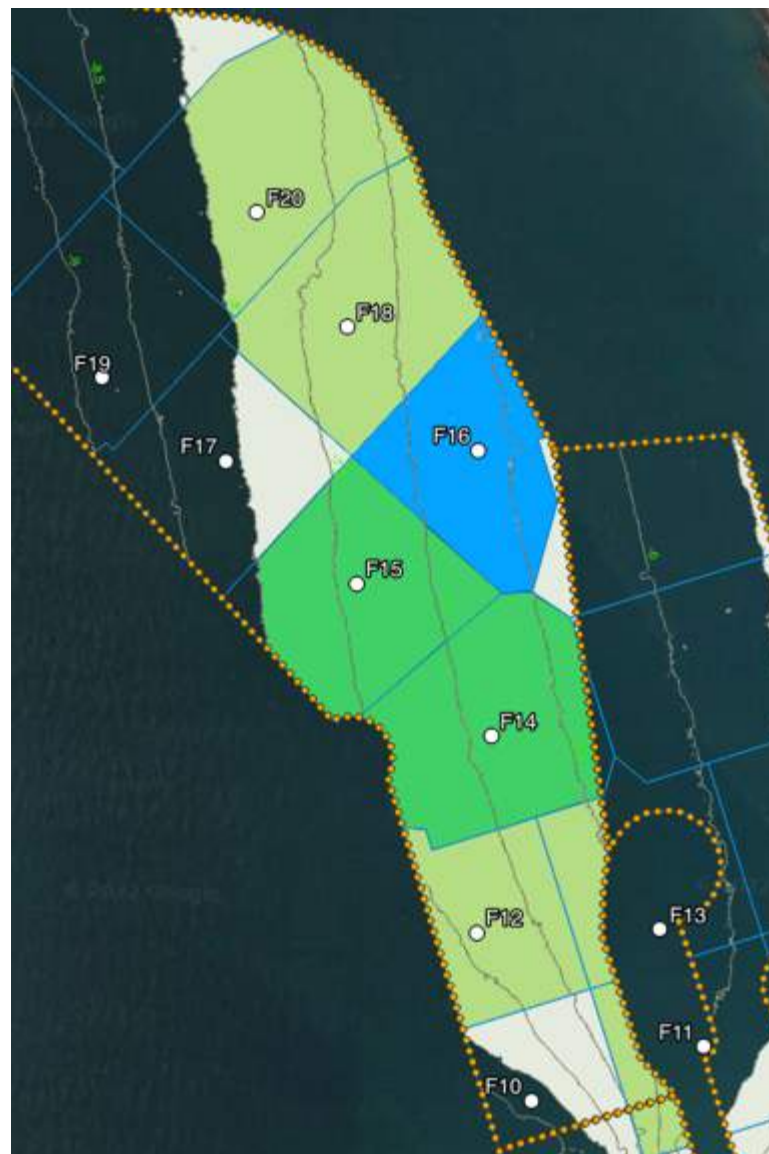
Rappresentazione in pianta delle classi di sedimento nell'intervallo di dragaggio - 7,5 m/-8,0 m
