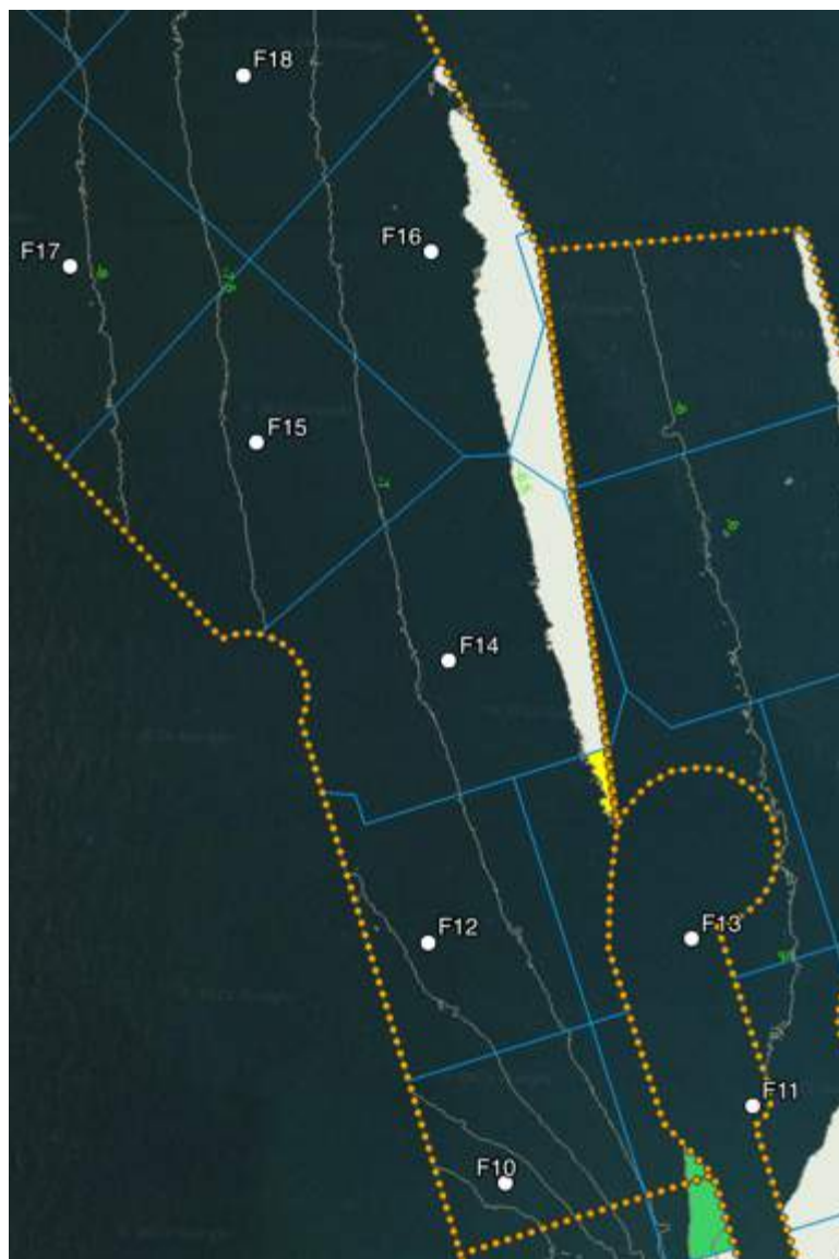
Rappresentazione in pianta delle classi di sedimento nell'intervallo di dragaggio - 6,0 m/-6,5 m
