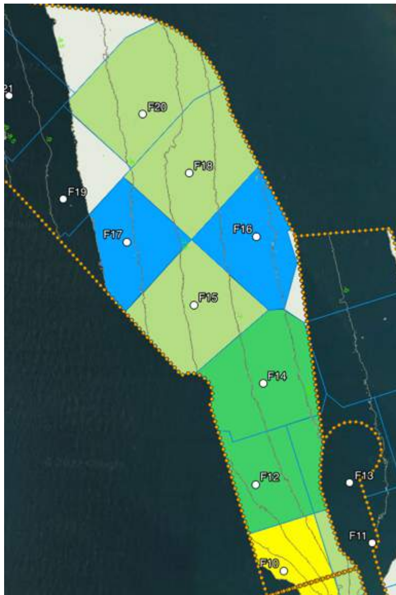
Rappresentazione in pianta delle classi di sedimento nell'intervallo di dragaggio - 8,0 m/-8,5 m
