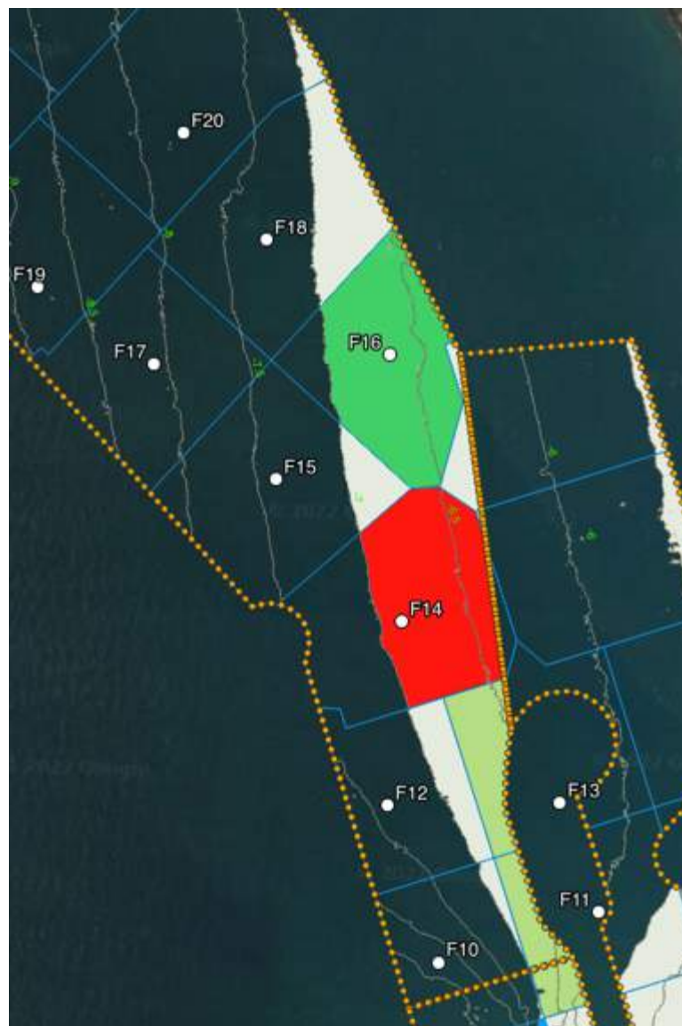
Rappresentazione in pianta delle classi di sedimento nell'intervallo di dragaggio - 6,5 m/-7,0 m
