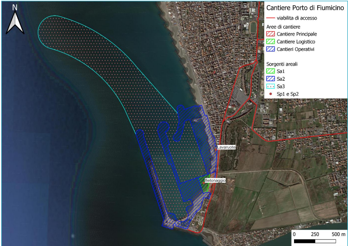
Figura 6.3: Individuazione delle sorgenti areali e puntiformi utilizzate il modello acustico delle attività lavorative all'interno dell'area di progetto
