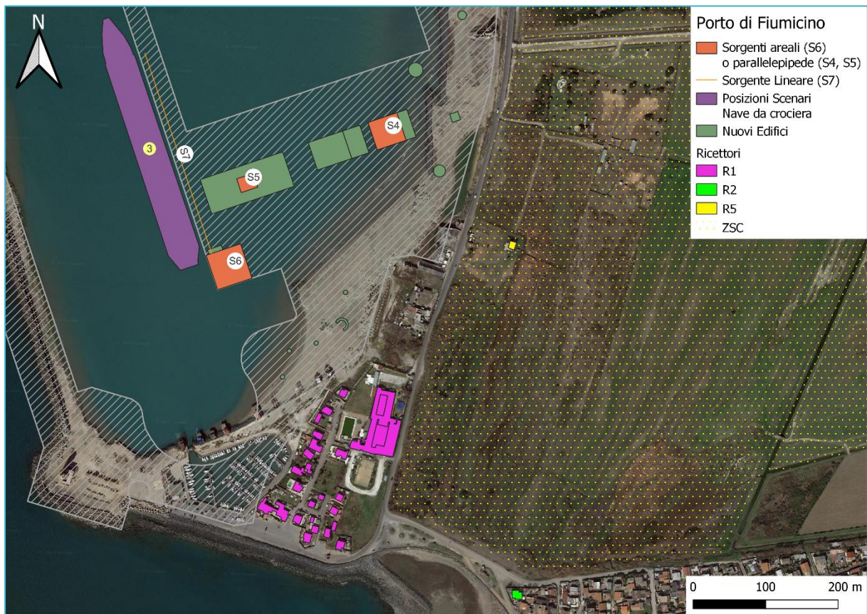
Figura 6.8: Inquadramento di dettaglio per l'individuazione delle sorgenti nell'area di progetto e inserite nel modello acustico per il calcolo dei livelli sonori indotti presso i ricettori individuati dal Porto di Fiumicino Isola Sacra durante la fase di esercizio
