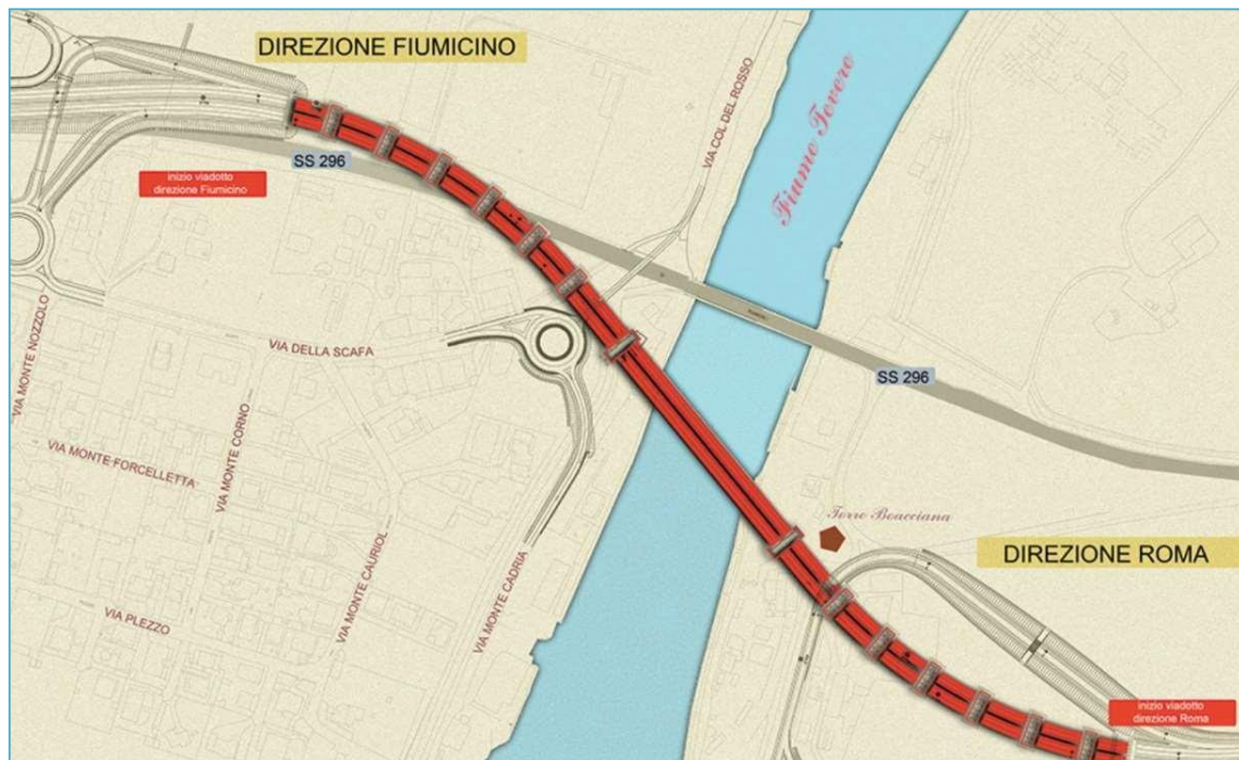
Figura 3.82: Schema progettuale del nuovo Ponte della Scafa
