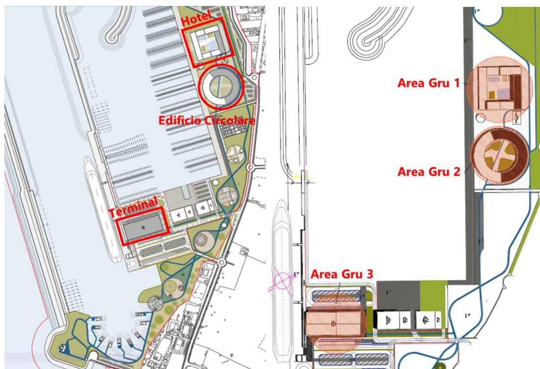
Figura 3.65: Aree di influenza delle gru durante le fasi di cantierizzazione del progetto e Edifici principali previsti presso il Porto turistico-crocieristico di Fiumicino Isola Sacra
