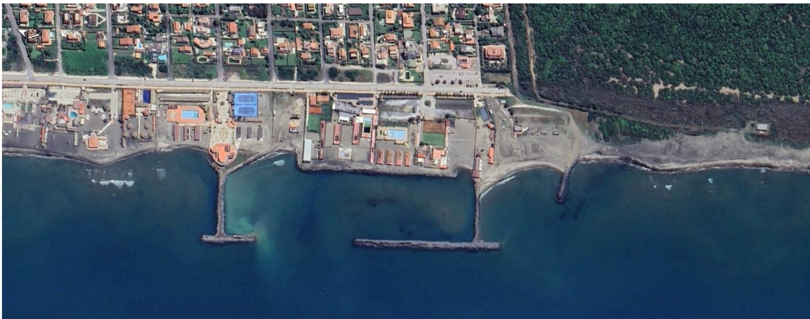
Figura 3.48: Foto aerea dell'intervento di difesa costiera finanziato dal Comune di Fiumicino; stato di realizzazione a maggio 2023
