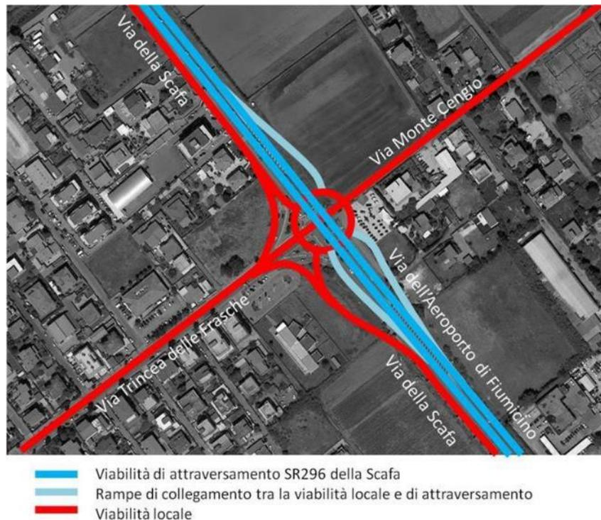
**Figura 4.26: Schema progettuale dello Svincolo a Livelli sfalsati per l'Intersezione tra Via dell'Aeroporto di Fiumicino e Via Trincea delle Frasche**
