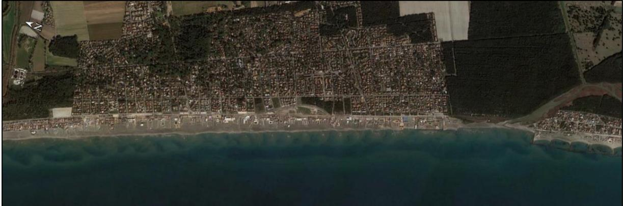
**Figura 3.18: Litorale di Fregene nel 2022: apprezzabile il forte arretramento della linea di riva a causa delle forti mareggiate**
