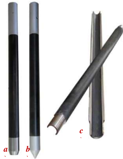
Fig. 6: Campionatore Raymond. a) a punta aperta; b) a punta chiusa; c) tubo diviso longitudinalmente senza punte.
