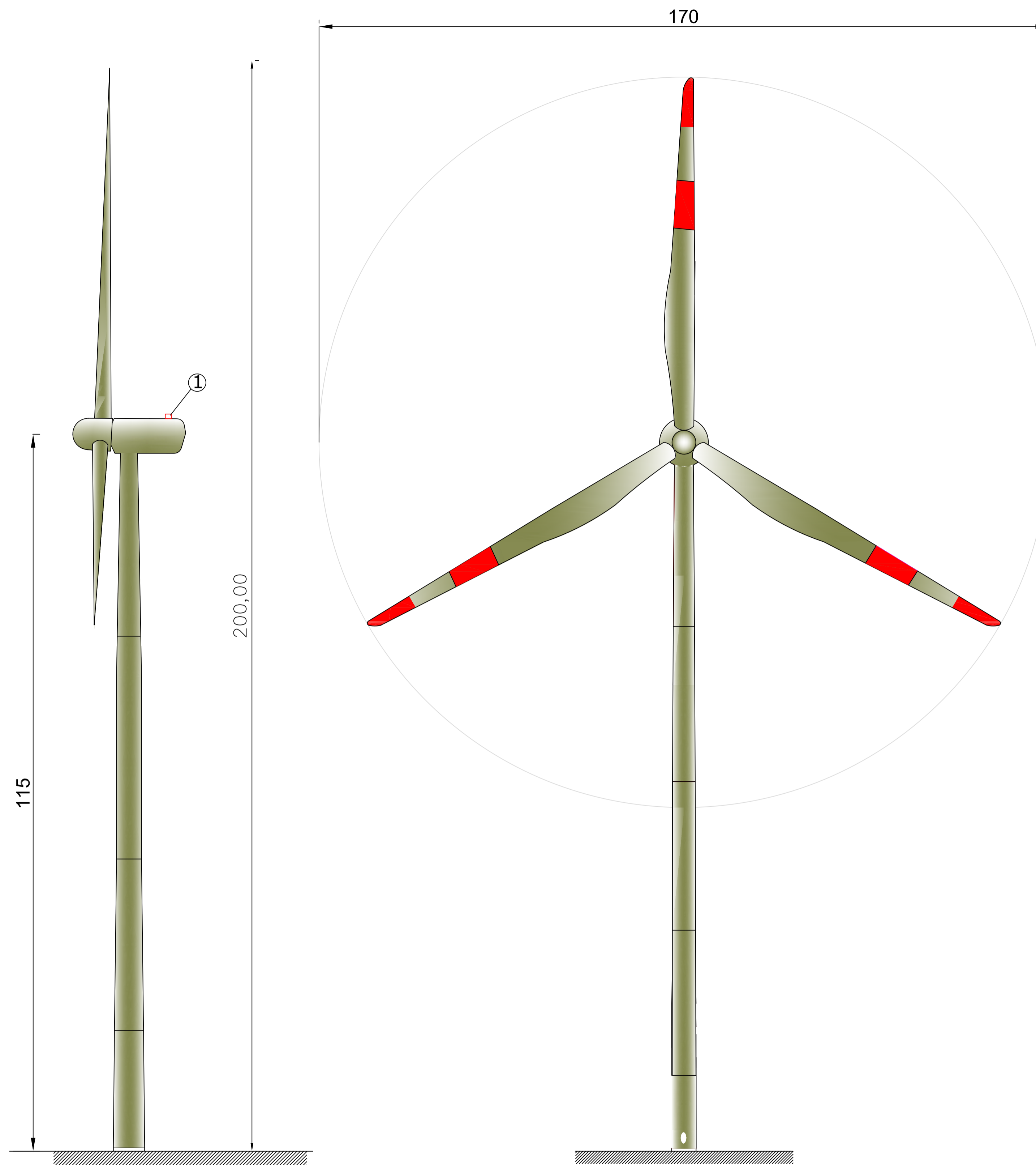
Aerogeneratore 6,0 MW - Altezza Hub = 115m Scala 1:100
