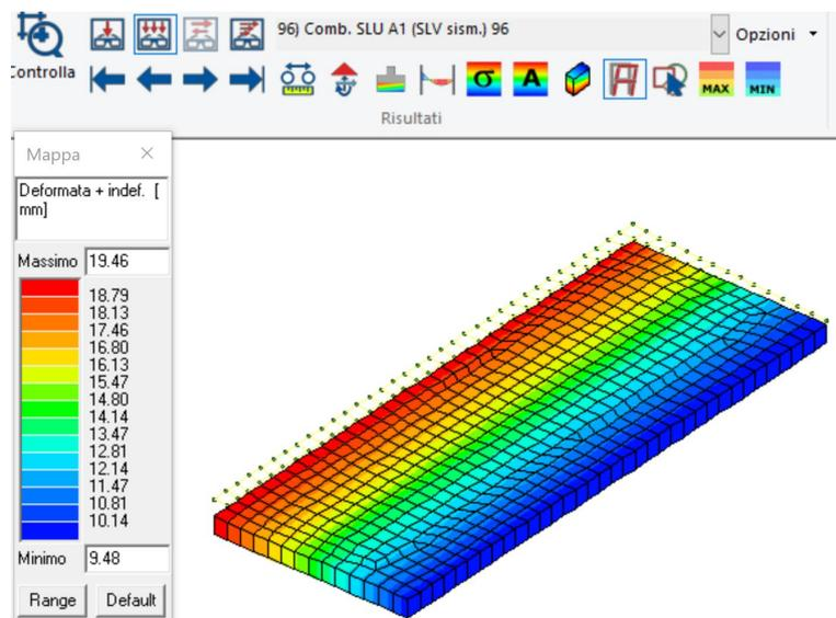
Figura 56 Deformazione MAX orizzontale Comb 96 SLV 19,46mm
