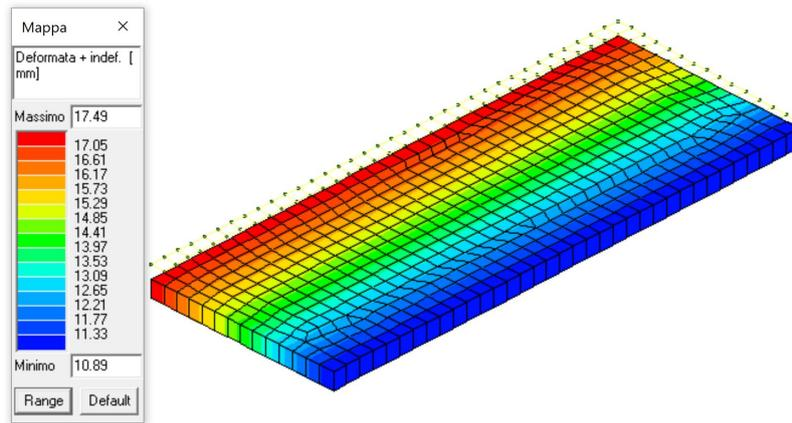
Figura 67 cedimento massimo frequente
