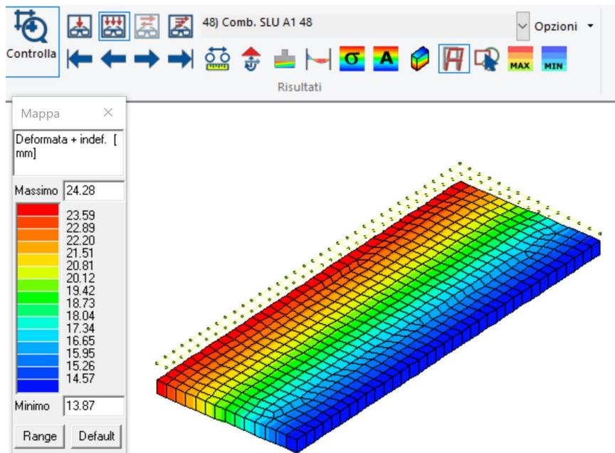
Figura 55 Deformazione MAX verticale Comb 48 SLU 24,28mm
