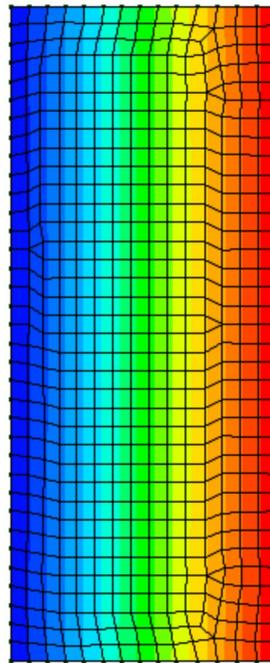
Figura 69 Tensioni MIN di contatto Comb SLU 48
