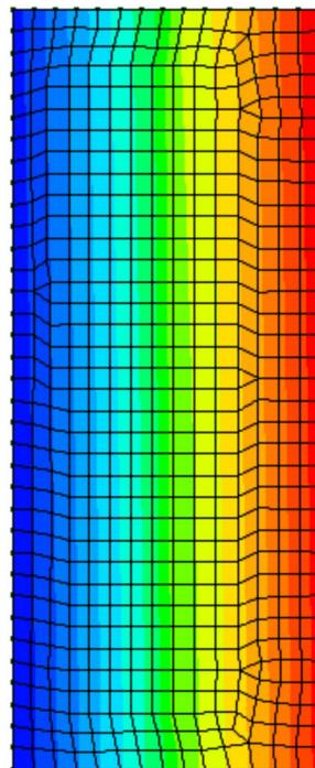
Figura 70 Tensioni di contatto MIN Comb SLV 96
