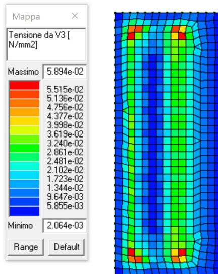
Figura 58 verifica tensionale V3 fondazione
