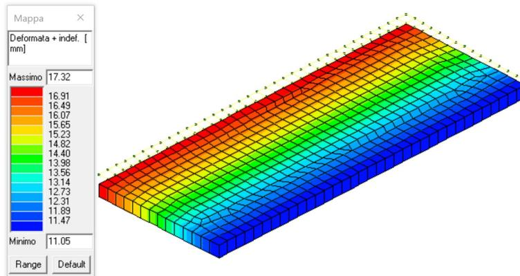
Figura 68 cedimento massimo permanente
