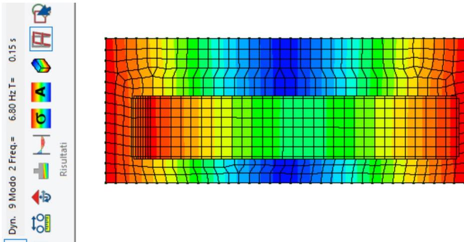
Figura 35 secondo modo: pianta
