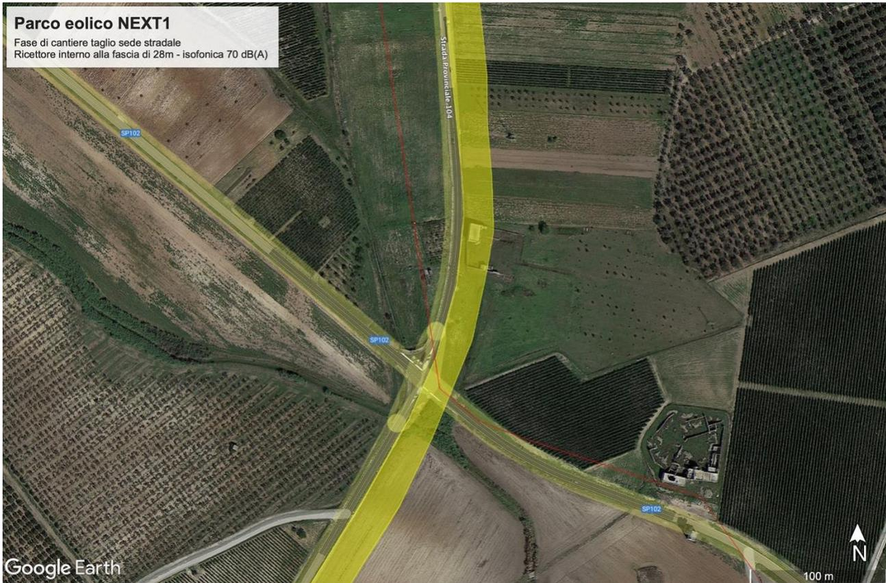
Figura 9: Fascia con livelli di emissione superiori a 70 dB(A) - fase di realizzazione cavidotto.
