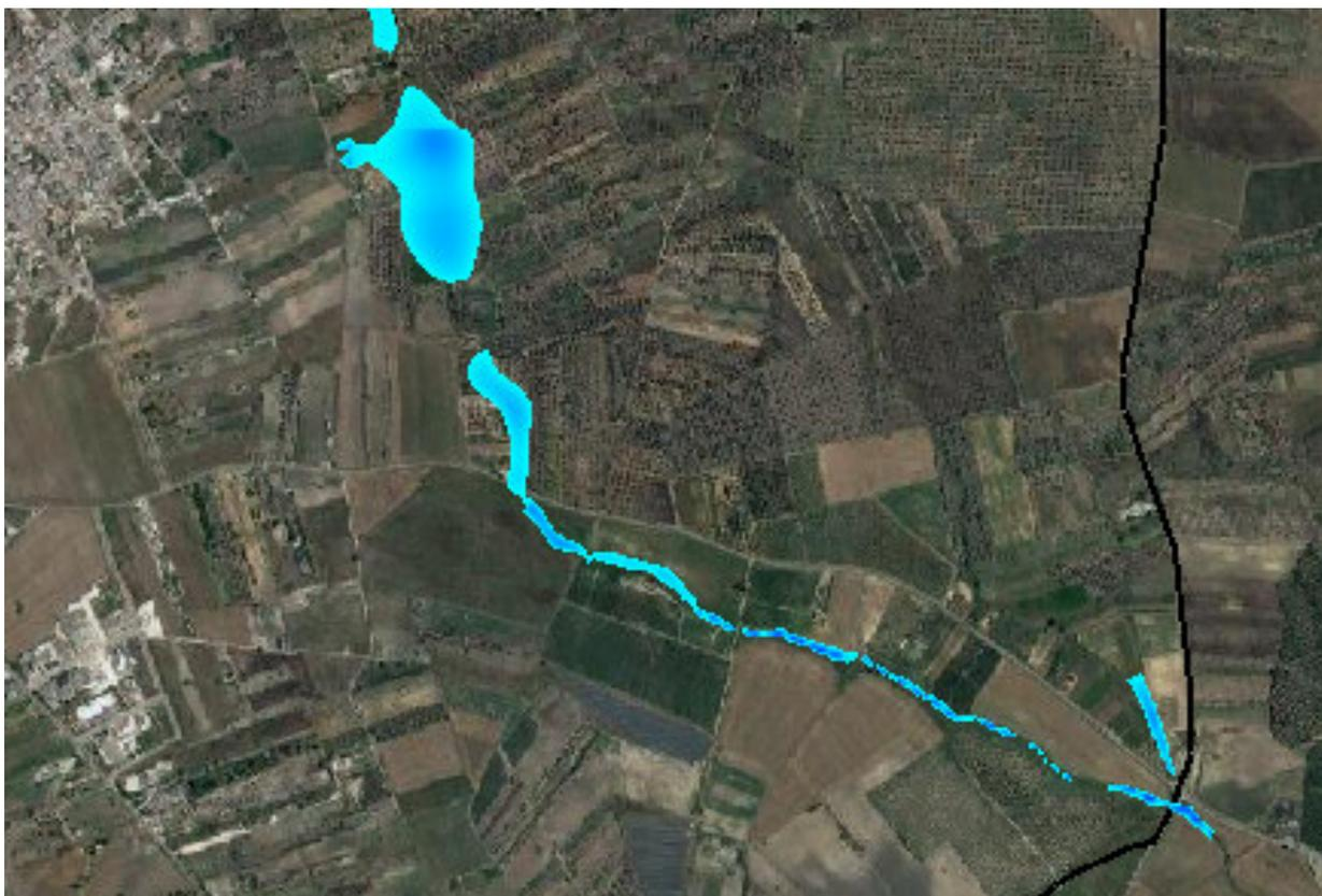
*Fig. 5.4.5 - Mappa di esondazione su ortofoto (dettaglio intersezione con il cavidotto)*
