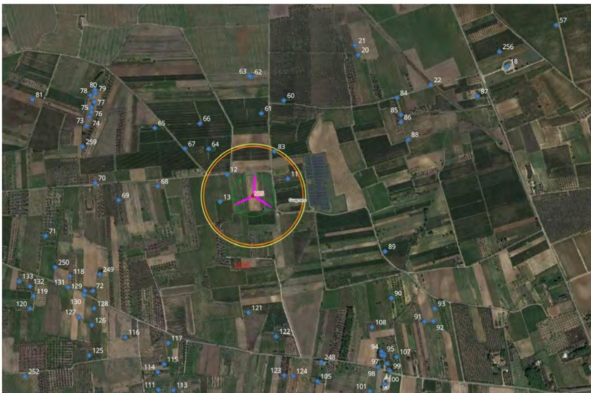
Figura 45b: Individuazione planimetrica dei ricettori nel buffer di 210 metri per la pala intera (GIALLA)
