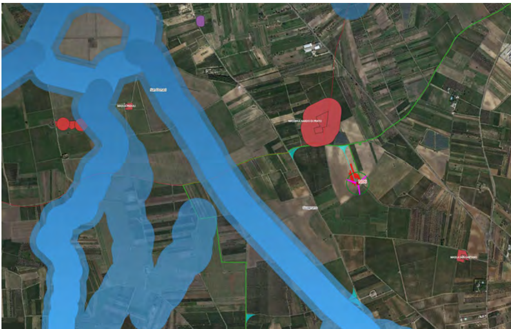
Interferenze idrauliche del cavidotto
